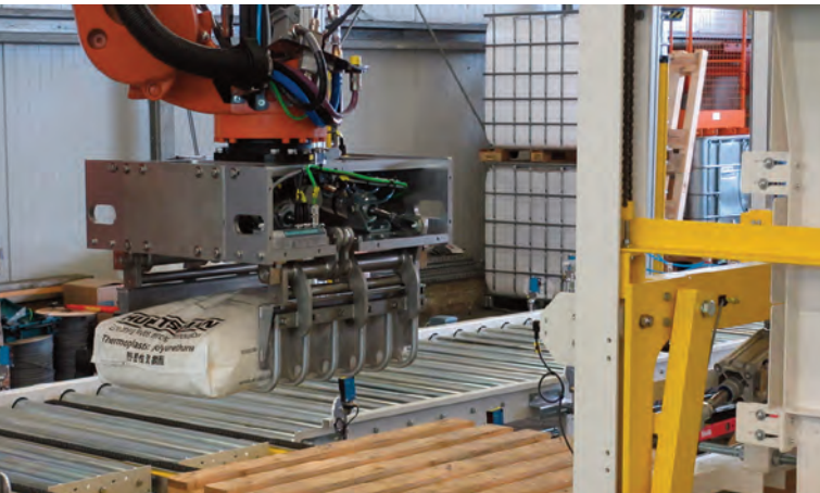
Sack-Palettierer mit Kombigreifer von SMB
